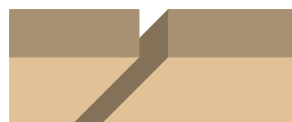
CODICE MR Pannelli con bordi dritti (misure ridotte per struttura "T a scatto")
