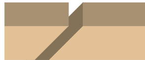
CODICE MR Pannelli con bordi dritti (misure ridotte per struttura "T a scatto")
